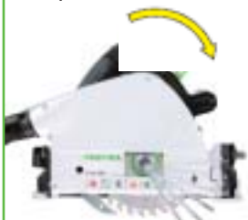
Etape 2 : dévisser la vis à six pans creux, changer la lame de scie et revisser.
