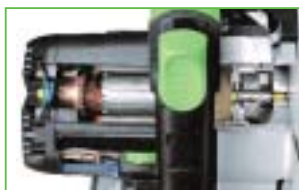
Solidité et silence : l'arbre de moteur tournant sur trois paliers.
